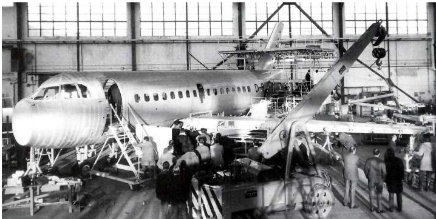
Flügelmontage an der G01 im Werk Bremen - Lieferung des Flügels von Fokker-VFW
